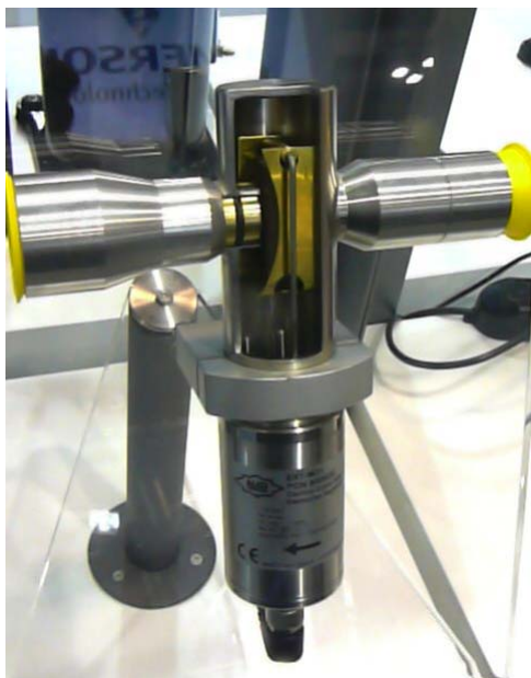
Obrázok 36 LEV s pohyblivým premenlivým prietočným otvorom
